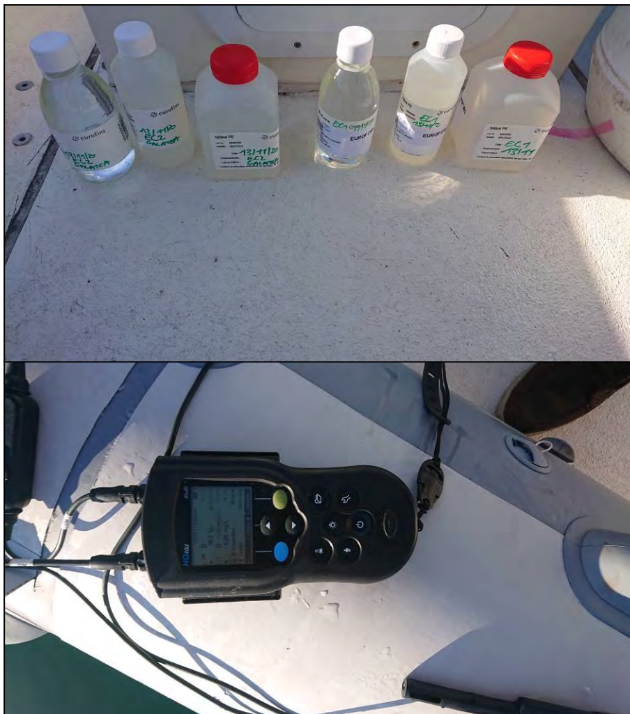
Figure 3 : A) Echantillons d'eau conditionnés dans leur flaconnage – B) Sonde multi-paramètres
